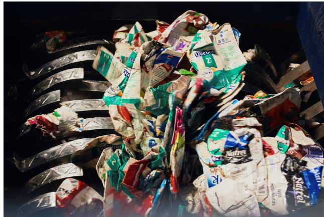
CMC en train d'être déchiquetés
