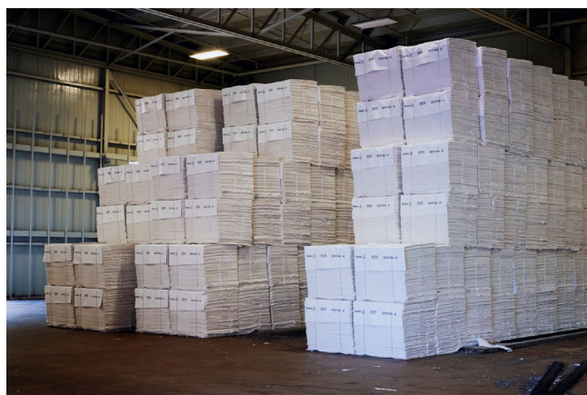
Feuilles de pâte à papier contenants de la fibre de CMC recyclée
