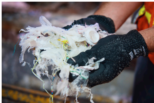
Polyéthylène et aluminium des CMC séparés de la fibre
