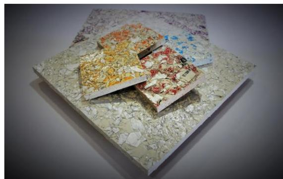
*ReWall transforme les contenants multicouches en matériaux de construction robustes et durables en exploitant sa technologie de recyclage écologique et écoénergétique. Photo courtoisie de la compagnie ReWall.*
