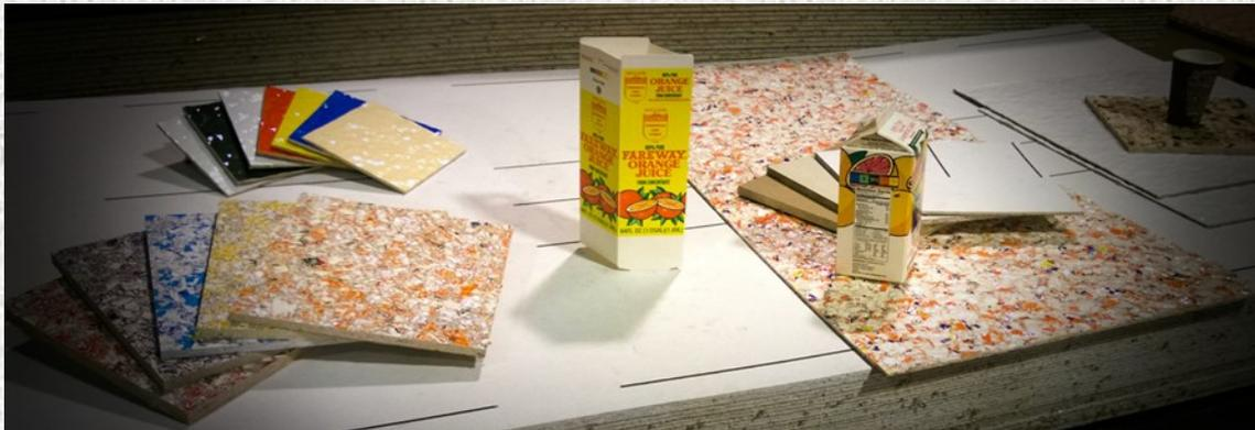
Environ 30 contenants multicouches sont utilisés pour produire une seule dalle de plafond ReWall de 2pi<sup>2</sup>. Source: The ReWall Company - [www.rewallsolutions.com](http://www.rewallsolutions.com).
